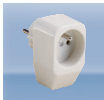
Zwischenstecker Thermoplast glasfaserverstärkter Kontaktträger, Steckerseite mit zwei Erdungs- systemen nach CEE 7/VII Steckdoseseite mit Erdungs- system nach CEE 7/V
