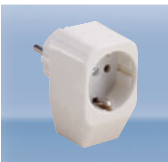
Zwischenstecker Thermoplast glasfaserverstärkter Kontaktträger, Steckerseite mit zwei Erdungssystemen nach CEE 7/VII
