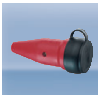
Kupplung 16 A mit Manschette und Verschlussdeckel nach SEV 5932 Typ 25 spritzwassergeschützt IP44
