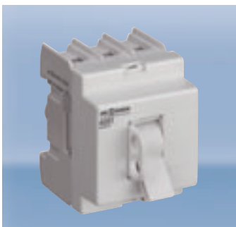
Ausschalter 3-polig 63 A 415 V~ Eingangsschalter für Stromkreis- verteiler, absperbar in „EIN“- oder „AUS“-Stellung max. Anschlussquerschnitt 25 mm 2
